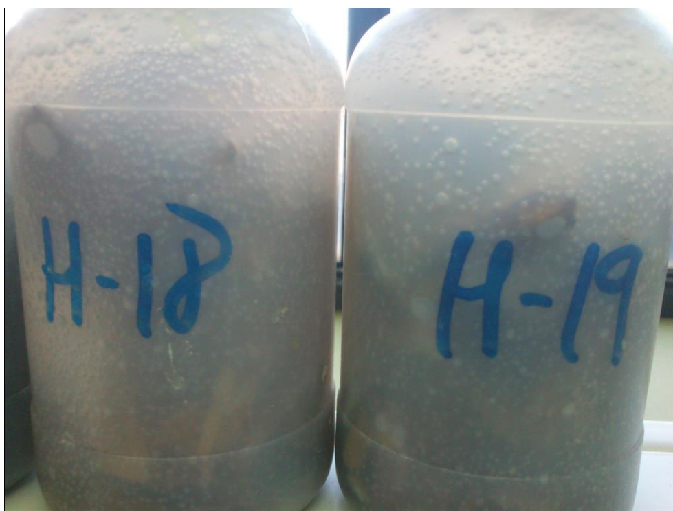
Figura 36. Ensayos de laboratorio realizados en el presente proyecto para evaluar el potencial neutralizador de diferentes tipos de roca encontrados en la corta Guadiana y su potencial emisor de CO 2 . Se aprecia el contenido gaseoso acumulado en la fase acuosa del interior de los botes, como consecuencia de la disolución en medio ácido (pH 1.5) de carbonatos presentes en estas rocas.
