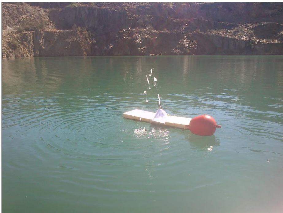
Figura 43. Funcionamiento del primer dispositivo de desgasificación instalado en el lago de la corta Guadiana en Abril de 2014, una vez purgado mediante una bomba de succión más potente en Octubre de 2014.
