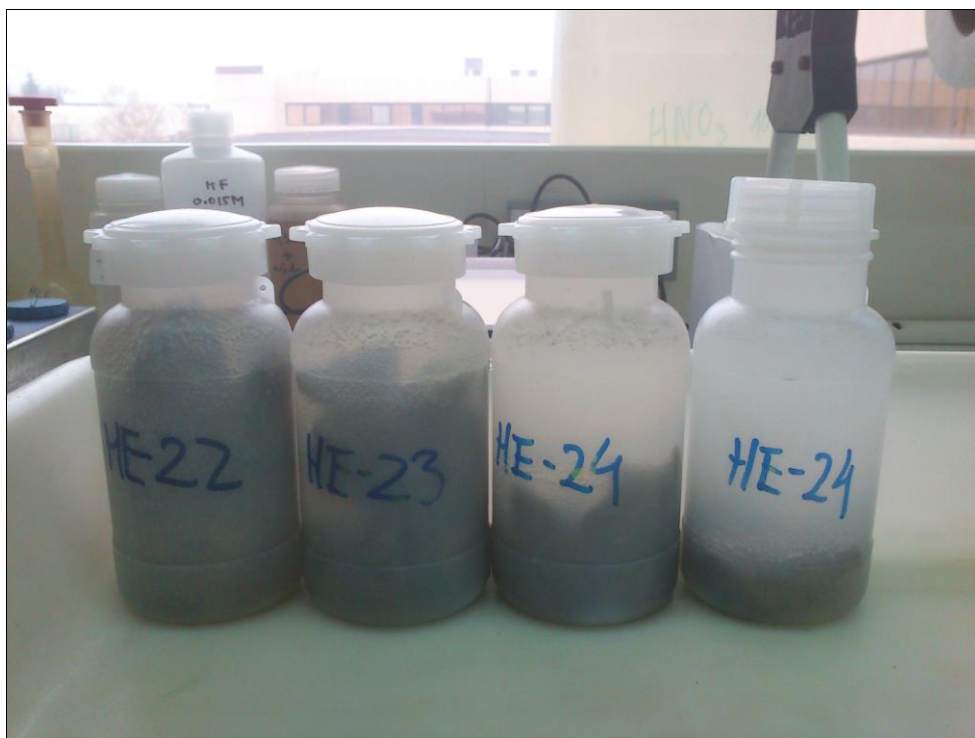
Figura 35. Ensayos de laboratorio realizados en el presente proyecto para evaluar el potencial neutralizador de diferentes tipos de roca encontrados en la corta Guadiana y su potencial emisor de CO 2 .
