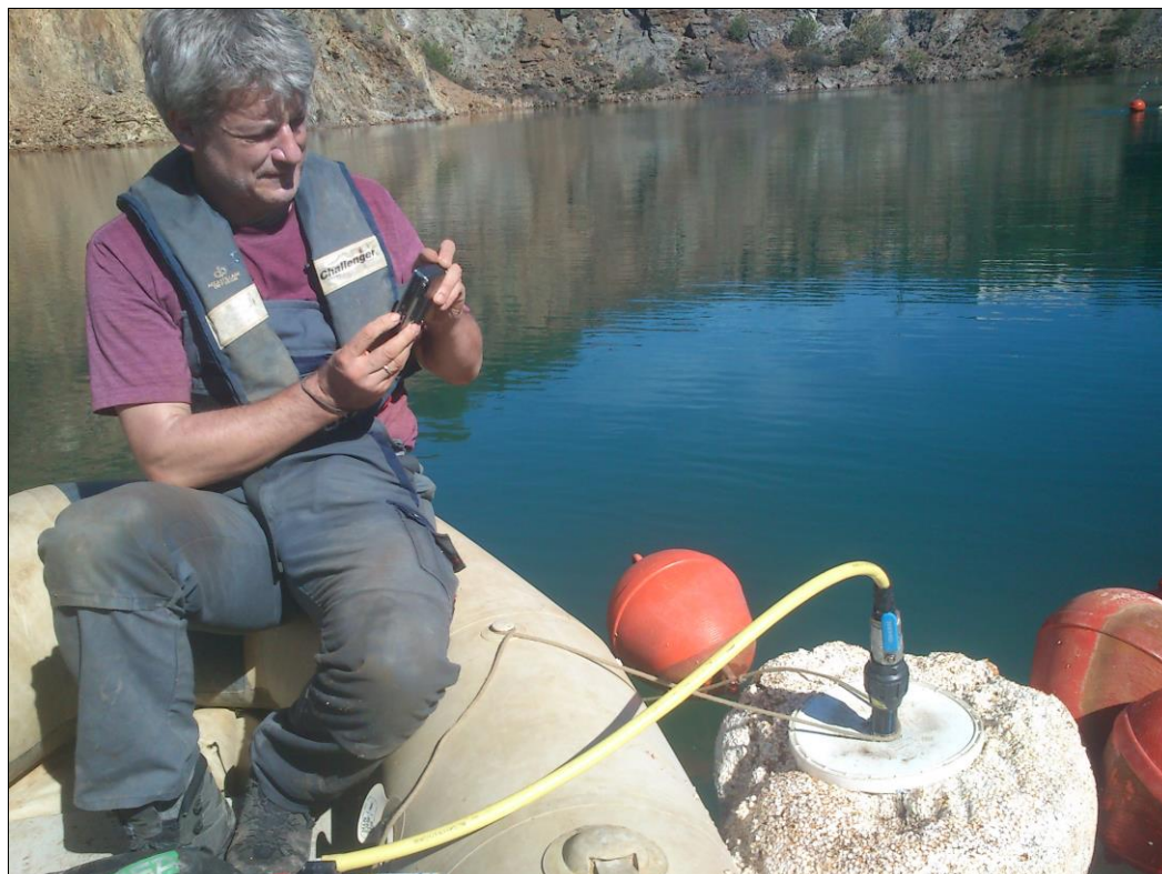
Figura 45. Primeras pruebas y bombeos en el segundo dispositivo de desgasificación en la corta Guadiana (Octubre de 2014).
