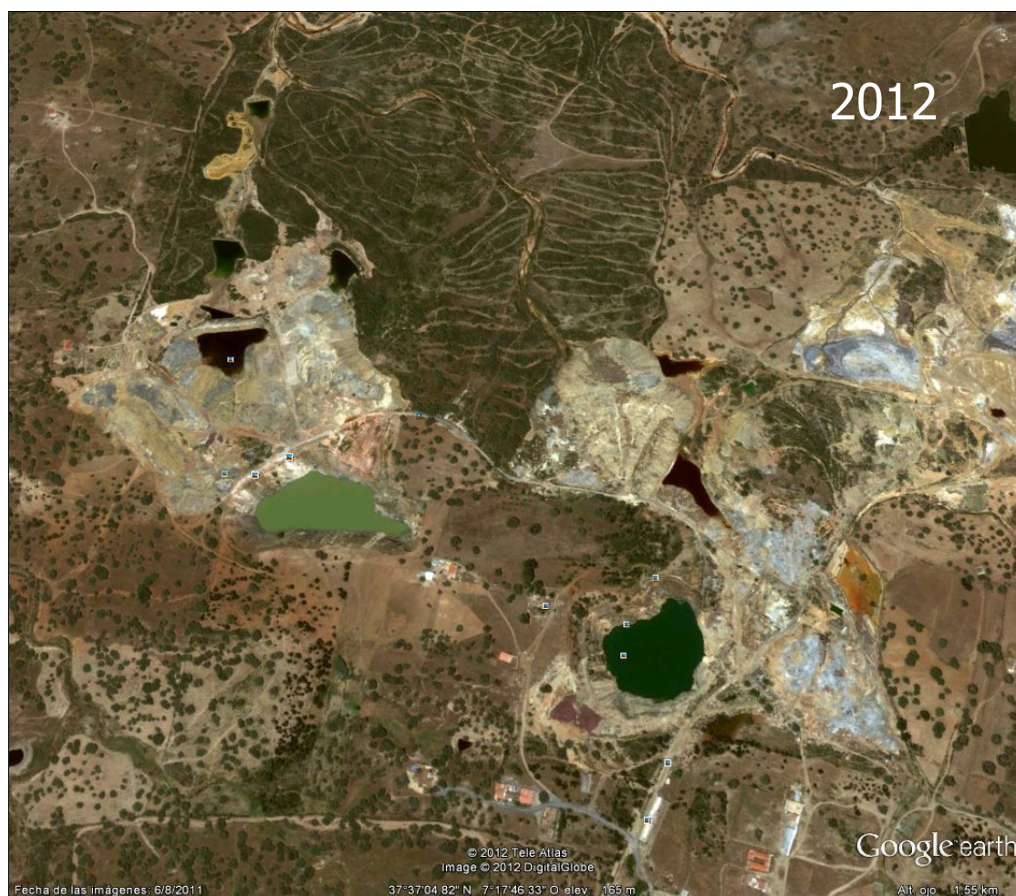
Figura 16. Imagen de la zona minera de Las Herrerías tomada en 2012, donde se aprecia el aumento del área superficial y volumen del lago formado en Corta Guadiana, así como su distinta morfología en vista aérea (compárese con imagen de la Figura 15).
