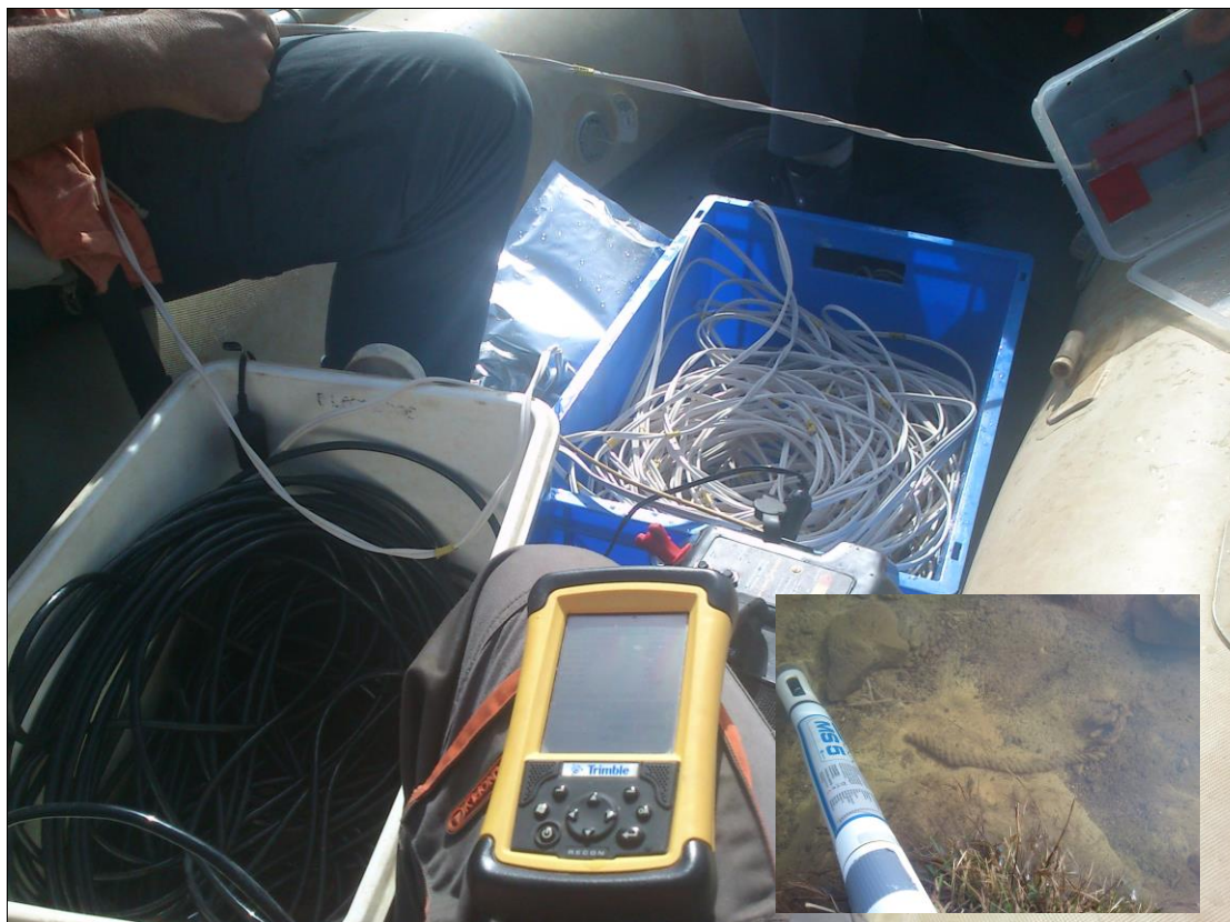
Figura 13. Material científico utilizado durante los trabajos de campo. De arriba hacia abajo y de izquierda a derecha: cable de suministro eléctrico para bomba sumergible para toma de muestras de agua profunda para medida de concentración de gases, cable de sonda multiparamétrica (100 m), PDA de control de la sonda, imagen de la sonda MS5 sumergida y equipada con sensor TDG para medida de gases disueltos.
